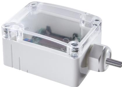
Batterie- und kabelloser Funk-Außenfühler zur Temperatur- und Lüftungsregelung. In zyklischen Abständen überträgt der Funk-Außenfühler die aktuelle Temperatur an die EnOcean Kommunikationsschnittstelle ems4.ENO1B. Mit integriertem Temperatursensor und solarbetriebenem Energiespeicher für einen wartungsfreien Betrieb.
