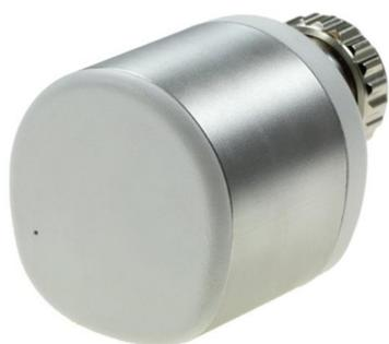
Batterieloser funkgesteuerter Ventilstellantrieb für Einzelraumregelung. Der elektronische Kleinstellantrieb nutzt die Temperaturdifferenz zwischen warmen Heizkörper und kühlerem Raum, um elektrische Energie mittels eines thermoelektrischen Generators zu gewinnen.
