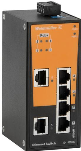
Der Switch bietet eine Lösung für den Einsatz von Power over Ethernet. 4 x IEEE 802.3af/at konforme PoE-Ports, mit integriertem DC/DC-Wandler zur Speisung von 48 V PoE-Geräten über den gesamten Eingangsspannungsbereich von 24 bis 48 VDC, intelligente Stromaufnahmeerkennung und Einstufung.
